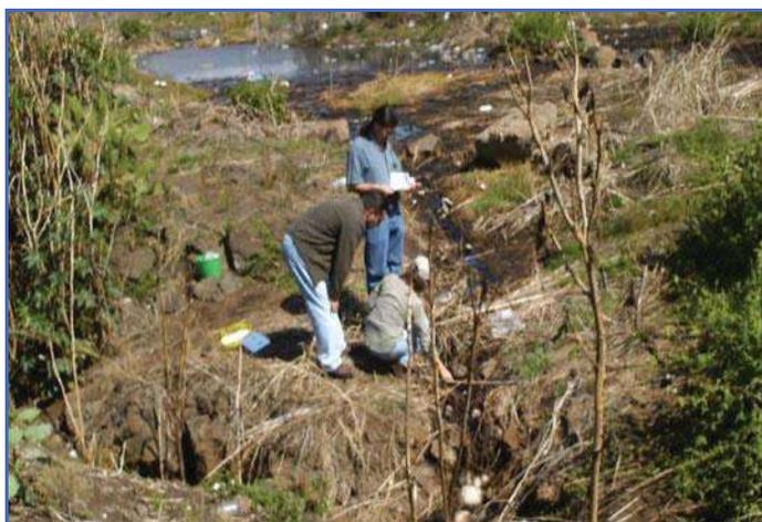
*Figura 49.- Recolección de lixiviado que ingresa a las fracturas del entorno, tomada en el tiradero de Morelia.*
