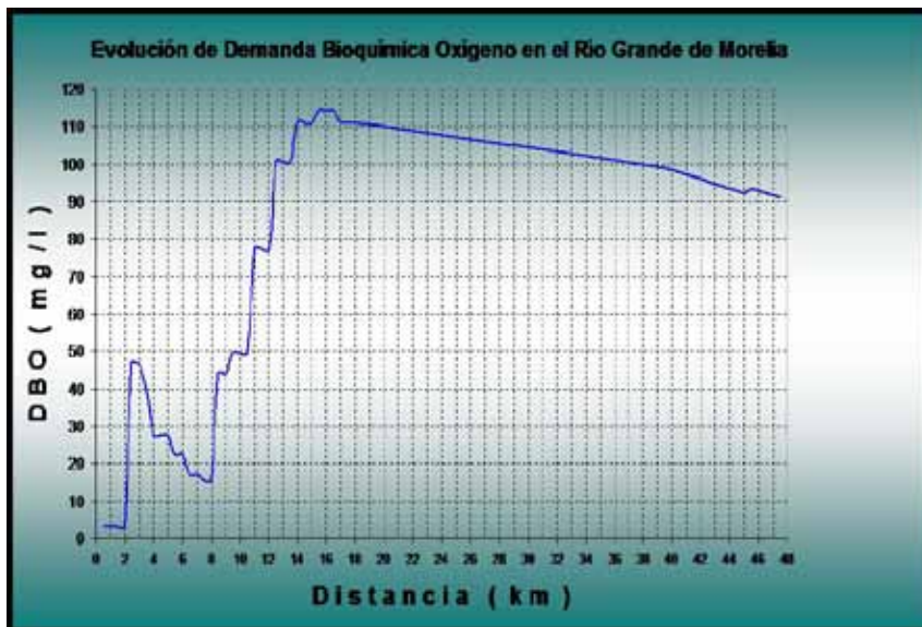
Figura 3. Evolución de la Demanda Bioquímica de Oxígeno en el Río Grande de Morelia, Michoacán.
